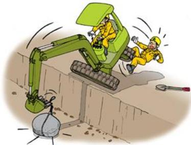
Gambar 69. *Excavator* terjungkal
