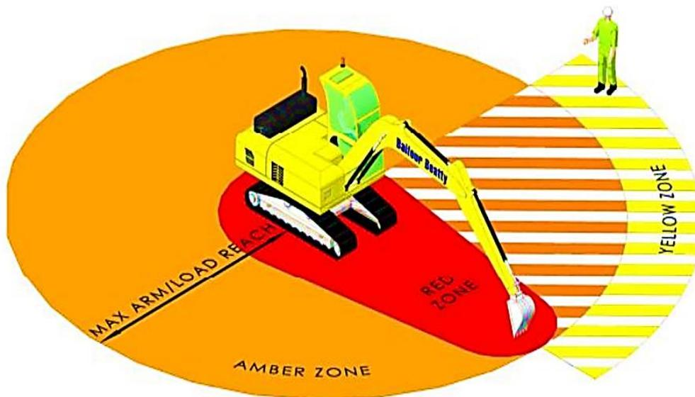
Gambar 18. Zona Keselamatan *Excavator clamshell*
